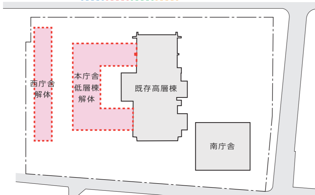
STEP 1 : 現本庁舎低層棟・西庁舎解体工事
