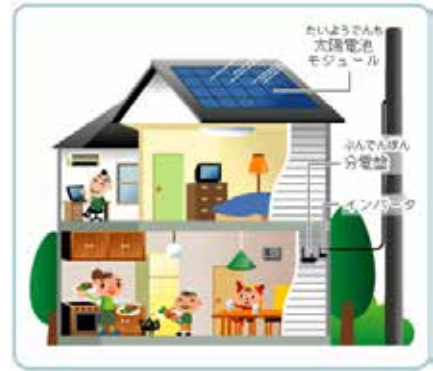
太陽光発電システムの仕組み
