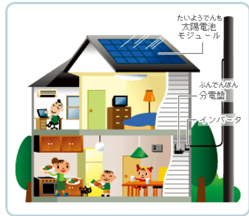
太陽光発電システムの仕組み
