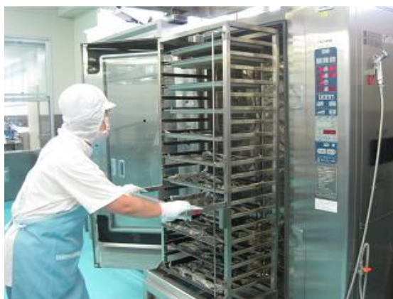
丸子学校給食センターのスチームコンベクションオーブン
