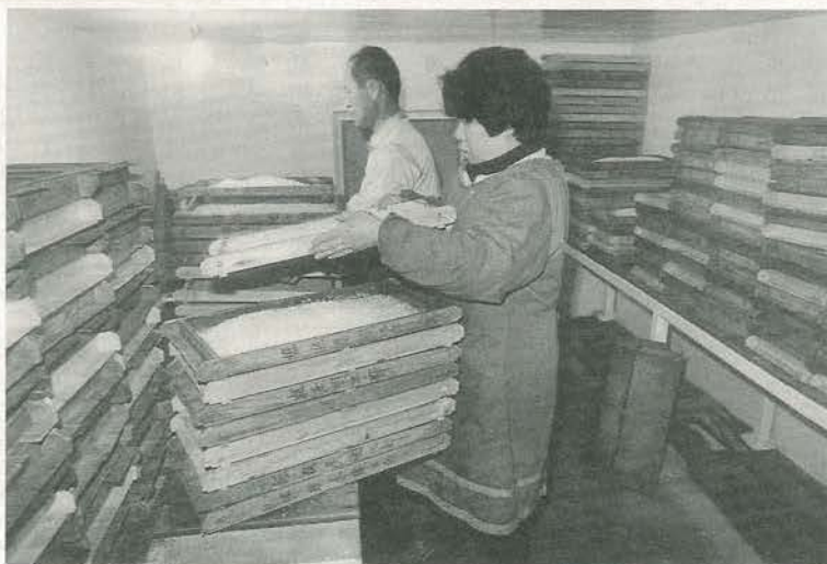
高温多湿の室の中での作業。一昔前までは炭をたいていた。今はサーモスタットで温度調整。糞は一度に250枚(升)が限度
