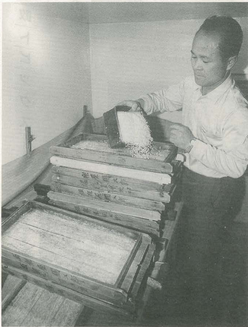
高温多湿の室の中での作業。一昔前までは炭をたいていた。今はサーモスタットで温度調整。糞は一度に250枚(升)が限度
